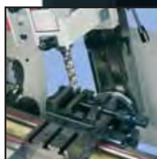
Na příčné lože je možné namontovat frézovací stůl
