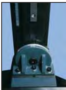
Frézku lze v podélné rovině nastavit pod úhlem ± 45°
