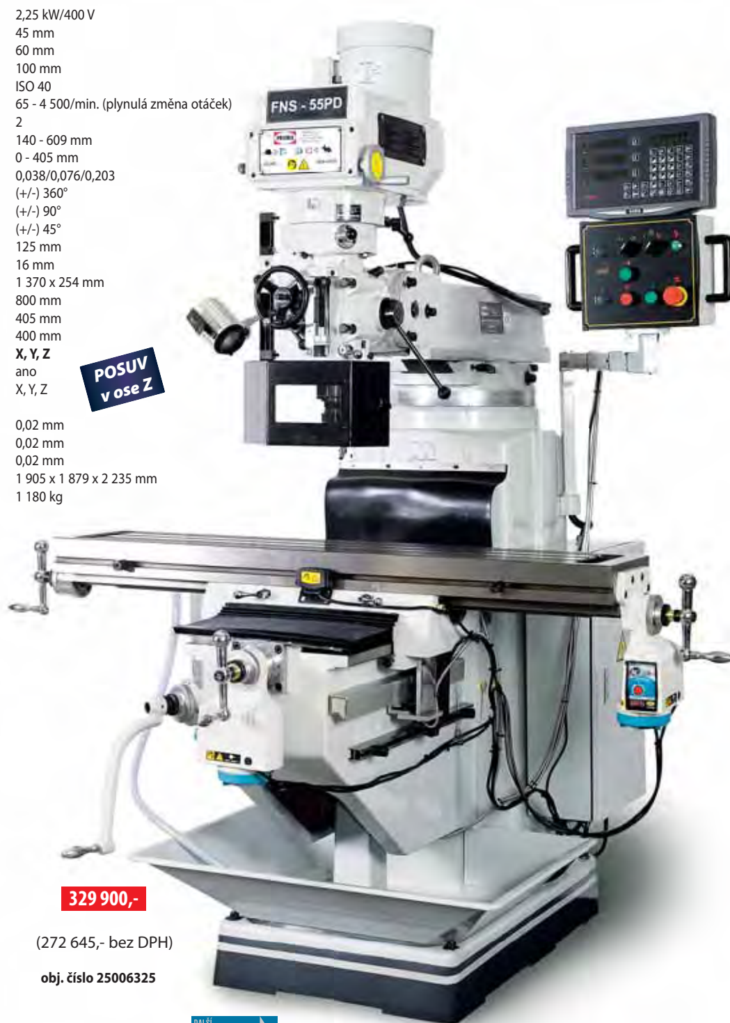
Strojní posuv s plynulou regulací a rychloposuvem
