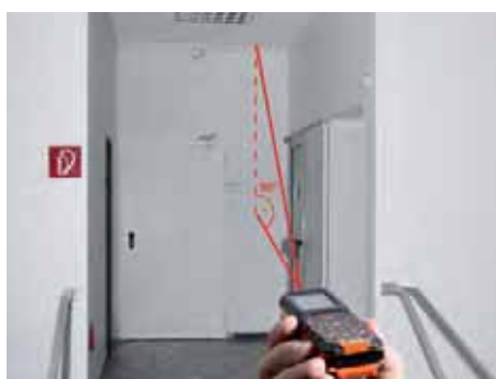
Tři typy nepřímého měření vzdálenosti
